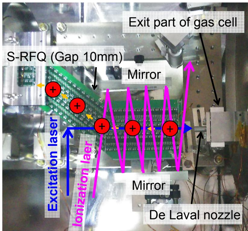
In-gas-jet laser spectroscopy
